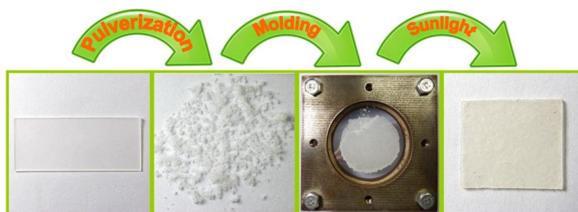
Рисунок 1.22 - Самозалечивания образца под действием УФ излучения [114]
